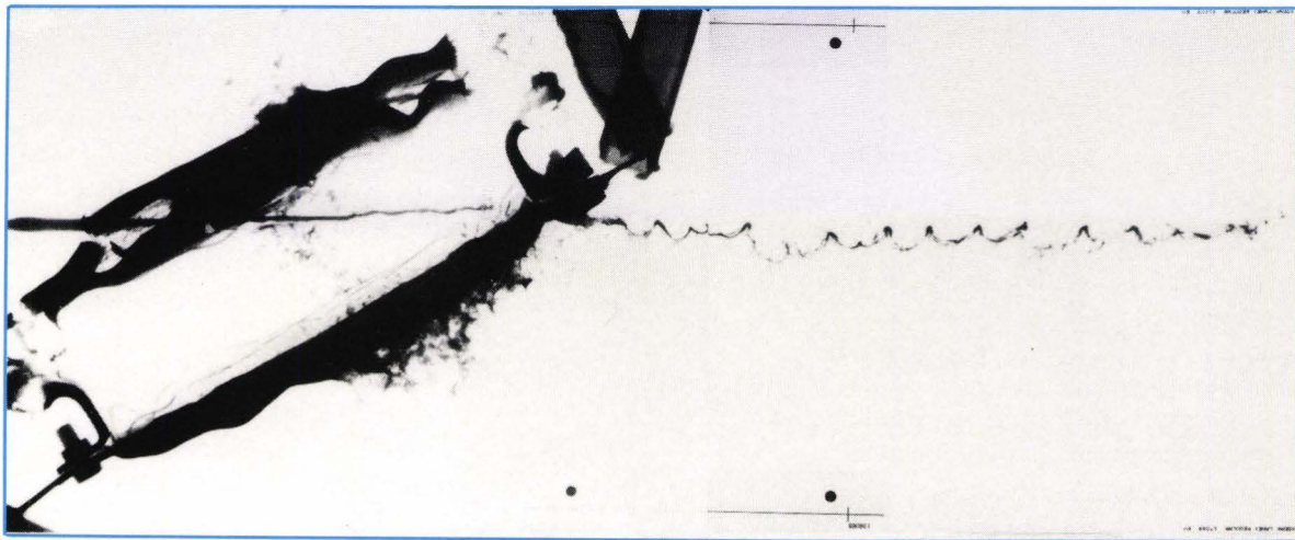
Afb. 7 Röntgenflitsopname van het effect van ERA op een holle-ladingsstraal; de straal komt van links, twee staalplaten worden door een dunne laag springstof uit elkaar gedreven, waarbij ze de straal verstoren
