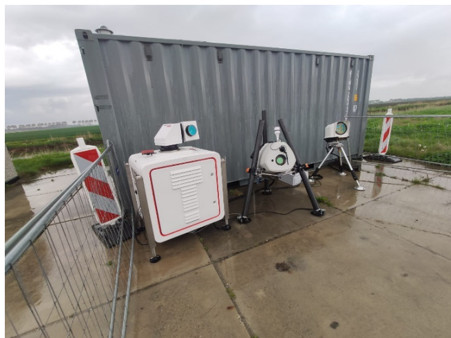
Figuur 2.7: Plaatsing van de twee nacelle lidars en scanning lidar in Wieringermeer
