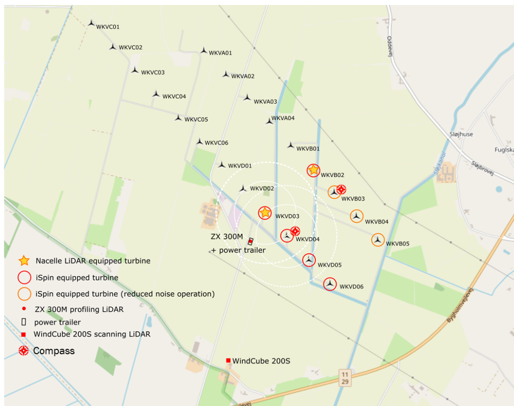
Figuur 2.1: Overzicht van meetinstrumenten in Klim Fjordeholme
