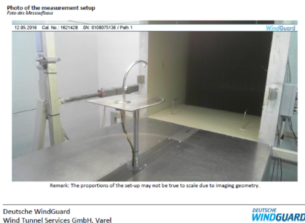
Figuur 2.2: Windtunnel kalibratie van iSpin sensor
