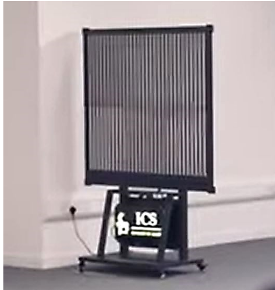
Figuur 18: Metasurface IRS voor de 3,5 GHz-band tijdens een prototypedemonstratie in 2021 [bron: 6GIC/ Youtube]
