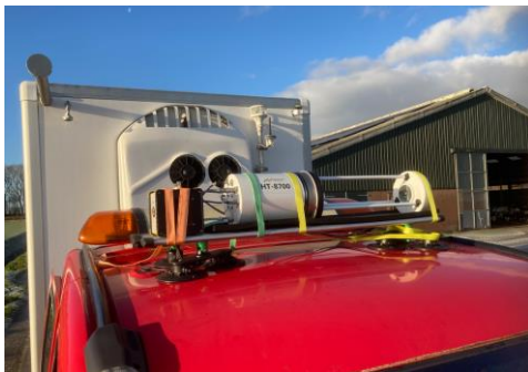
Figuur 33: Links: de HT-8700 voor metingen van ammoniak bevestigd op het dak van de trailer van de mobiele meetwagen. Rechts: ammoniak (paars) en methaan (rood) emissies gemeten uit een bemest weiland (linkerpiek) en de daarnaast gelegen melkveehouderij (rechterpiek). Voor deze grafiek is de meetwagen langs beide bronnen gereden en de grafieken van de heen- en terugweg zijn over elkaar heen geplot. Dit toont aan dat de metingen goed reproduceerbaar zijn.
