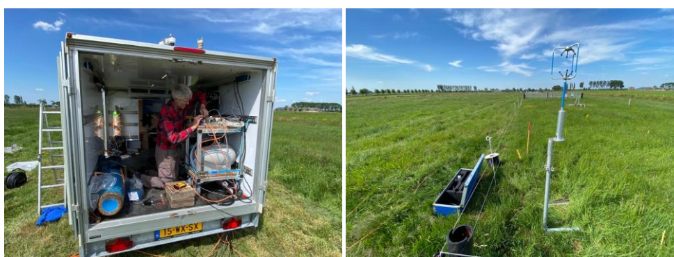
Figuur 12: Impressie van N 2 O metingen op 3 velden in Zegveld. Deze metingen worden gedaan om de bodemdaling en bijbehorende broeikasgasemissies in kaart te brengen.
