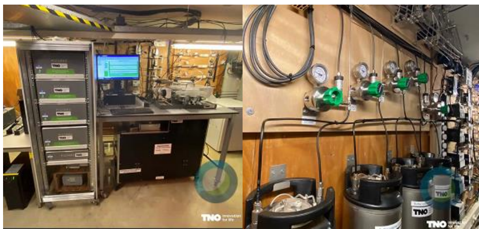
Figuur 2: Links: Een nieuwe set Picarro analyzers naast het Spectronus FTIR instrument op Cabauw. Rechts: testen van verschillende buffertanks gekoppeld aan de inlaatleidingen die bemonsteren op 27, 67, 127 en 207m hoogte.
