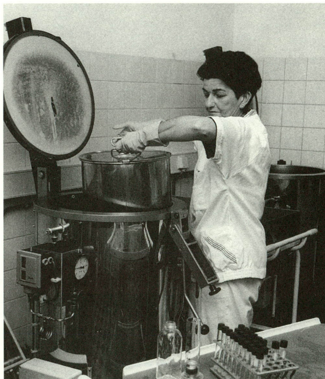
AUTOCLAAF VOOR HET DESINFECTEREN VAN BESMET AFVAL UIT MICROBIOLOGISCHE LABORATORIA. FOTO J. RUITER
