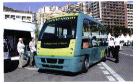
Volledig automatisch geleid op eigen baan. Kruisingen met ander verkeer (RIVM, Capelle aan den IJssel)
