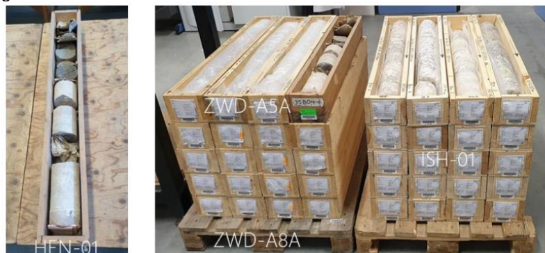
Figuur 4 Kernmateriaal van verschillende putten
