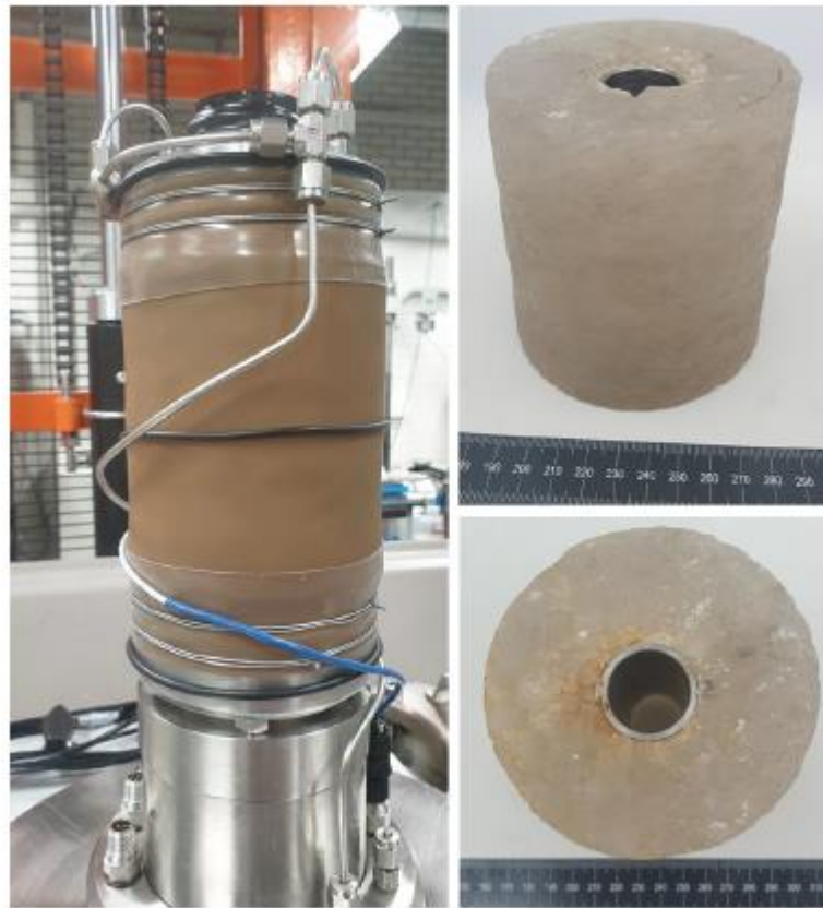
Figuur 5 Impressie van het geschaalde putmodel en de testopstelling gebruikt voor de experimenten in het lab
