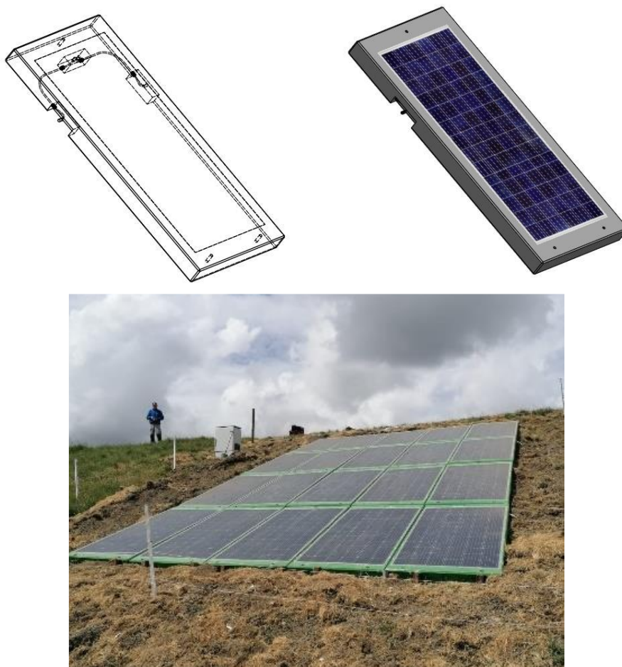
Figuur 5: Schematische weergave van een enkel betonelement (boven). Delmeco systeem na het aanbrengen van de betonelementen (onder)
