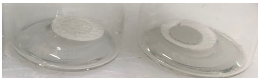
Figuur 12. Filter residuen van testwater filtraties. Links: PET in water, Rechts: PET en detergent en water
