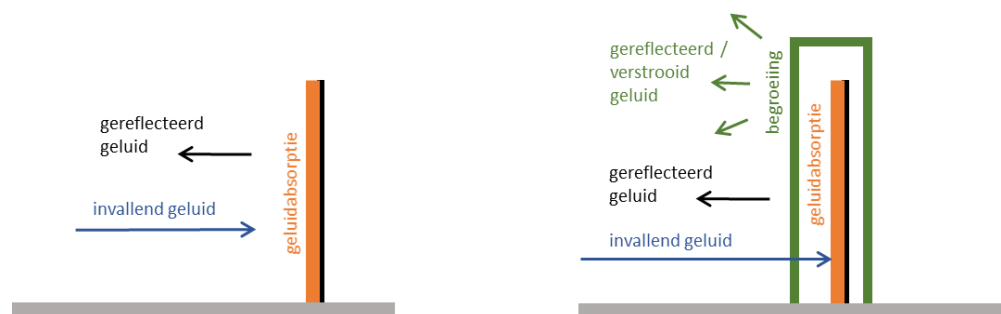
Figuur 2.7 Illustratie van reflectie, absorptie en verstrooiing van geluid bij een verticaal geluidabsorberend scherm (links) en hetzelfde scherm dat is omhuld door een met planten begroeid rooster (rechts).
