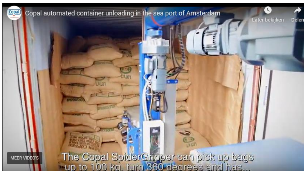
Figuur 2: Geautomatiseerd laden en lossen van zeecontainers met zakken met grondstoffen (bron: internet).
