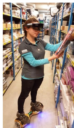
Figuur 6: Experiment met HoloLens mixed reality bril en hoverboard om productiviteit bij het orderpicken te verhogen.
