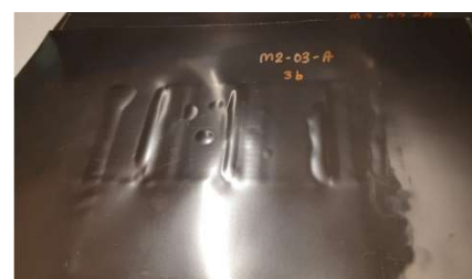
Figuur 13: zichtbare delaminatie
