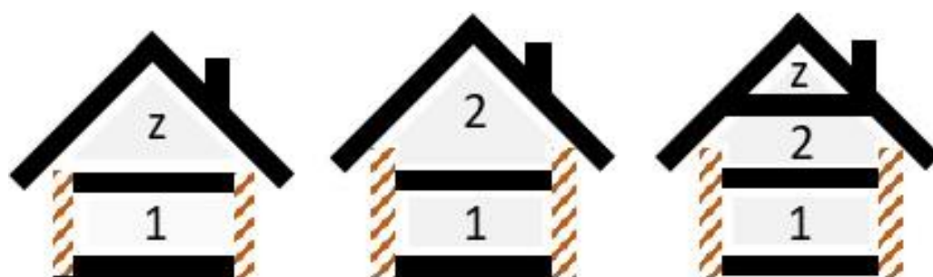
Figuur 11: Voorbeelden van doorsneden met 1 bouwlaag met opgaand metselwerk.
