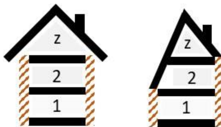
Figuur 11: Voorbeelden van doorsneden met 1 bouwlaag met opgaand metselwerk.
