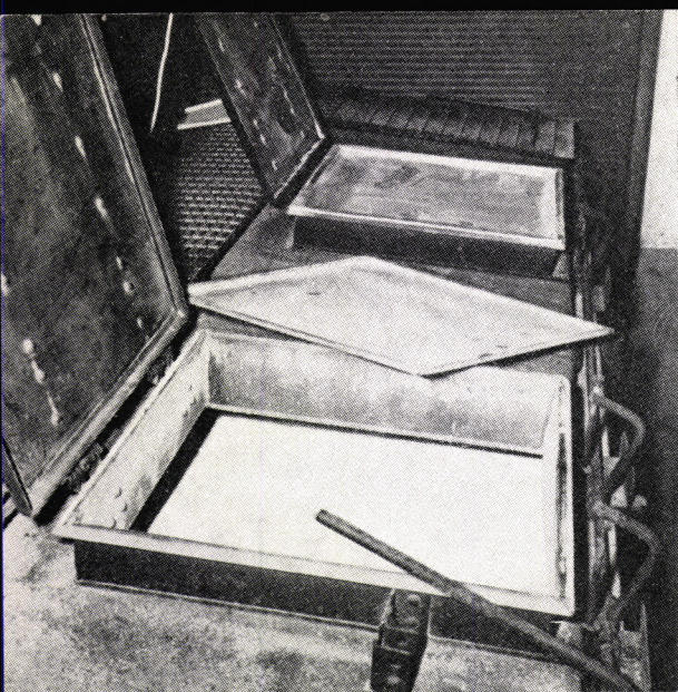
Fig. 17. Bovenkant van de Standard Covered Hopper Car; het met neopreen geïmpregneerde deksel, dat de inhoud van de wagon volledig beschermt, is duidelijk te zien.
