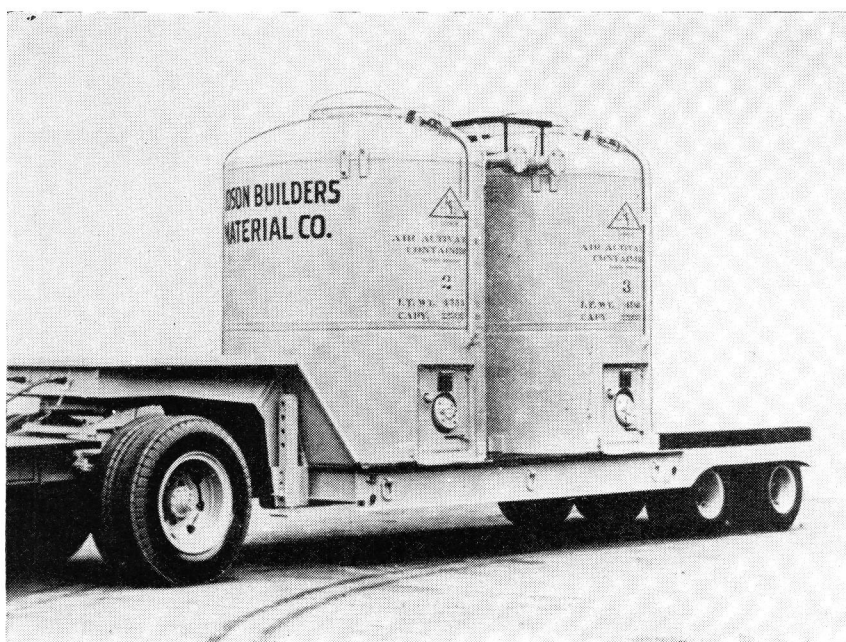
Fig. 3. 2 LCL-containers, gemonteerd op trailer
