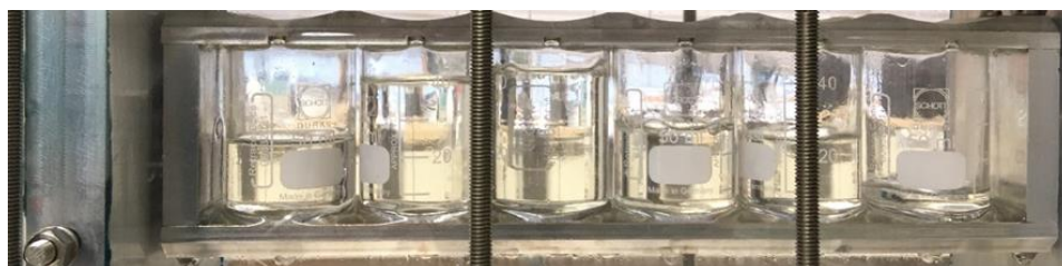
Figuur 6: Vloeistofopvang onder de plaatpakking
