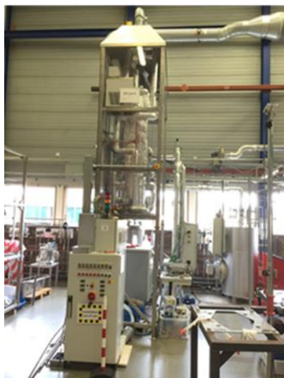
Figuur 9: TNO bench-schaal HIDiC installatie
