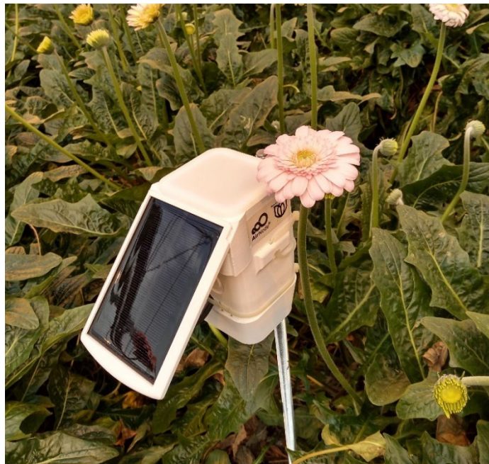
Figuur 1. Geventileerde Sigrow-sensor met ingebouwde sensoren voor T, RV en PAR.
