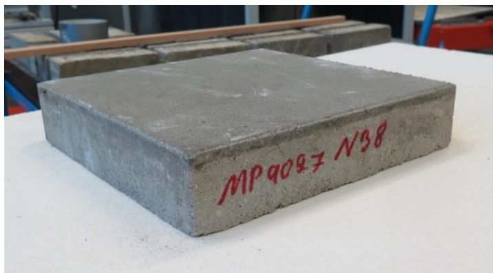
Figuur 30. Pilot Gemeente Dordrecht: geopolymer betontegel met cementgebonden toplaag.
