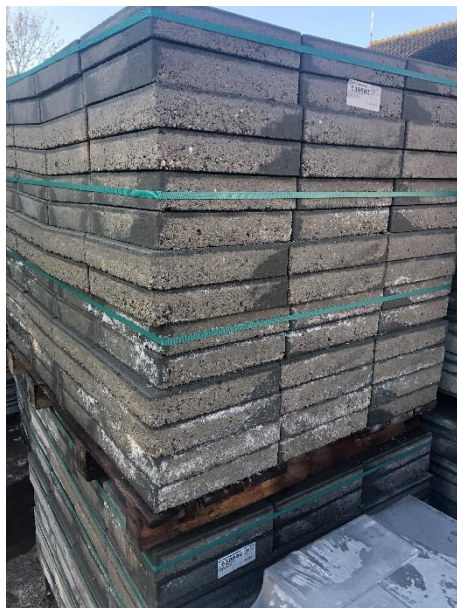
Figuur 17. Pilot Gemeente Amsterdam: geopolymer betontegels met cement gebonden toplaag in tas.
