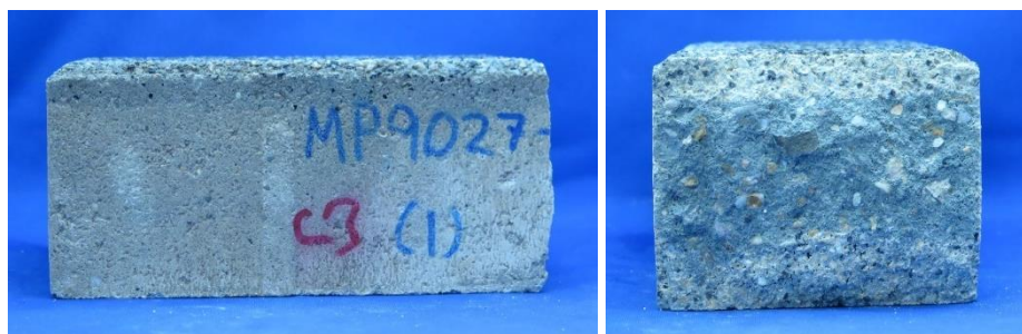
Figuur 12. Pilot Gemeente Rotterdam: voorbeeld toegepaste geopolymer betonstraatstenen met cement gebonden toplaag.
