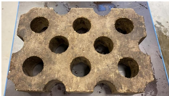
Figuur 32. Pilot Provincie Groningen: toegepaste geopolymer grasbetontegel.
