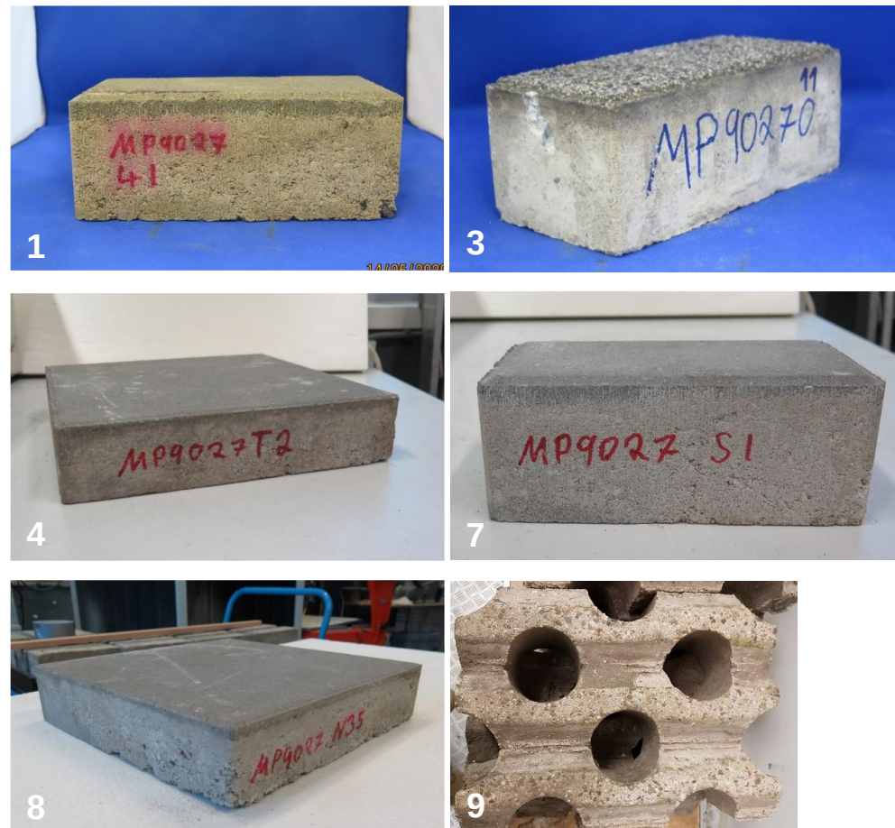
Figuur 36. Proeftuin Geopolymeren: uit het werk genomen geopolymeer beton-waren na een jaar. De nummers corresponderen met het pilotonummer. 1 – Gemeente Alphen aan den Rijn. 3 – Gemeente Rotterdam. 4 – Gemeente Amersfoort. 7 – Gemeente Nijmegen. 8 – Gemeente Dordrecht. 9 – Provincie Groningen. Van pilot 5 – Gemeente Amsterdam is geen foto beschikbaar.
