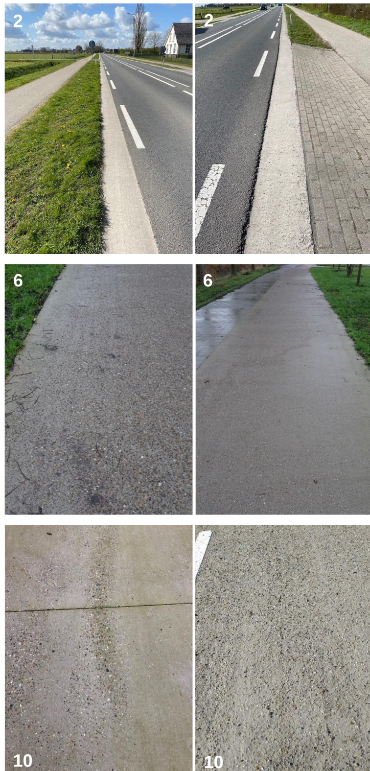
Figuur 37. Proeftuin Geopolymeren: impressie van de pilots met in het werk gestort geopolymer beton. De nummers corresponderen met het pilotnummer, 2 – Provincie Gelderland, na 22 maanden (na de vorst van februari 2021). 6 – Gemeente Leeuwarden, na 13 maanden (voor de genoemde vorstperiode); links de eerst gestorte moot, rechts de laatst gestorte. 10 – Provincie Overijssel, na 14 maanden (na de vorstperiode).
