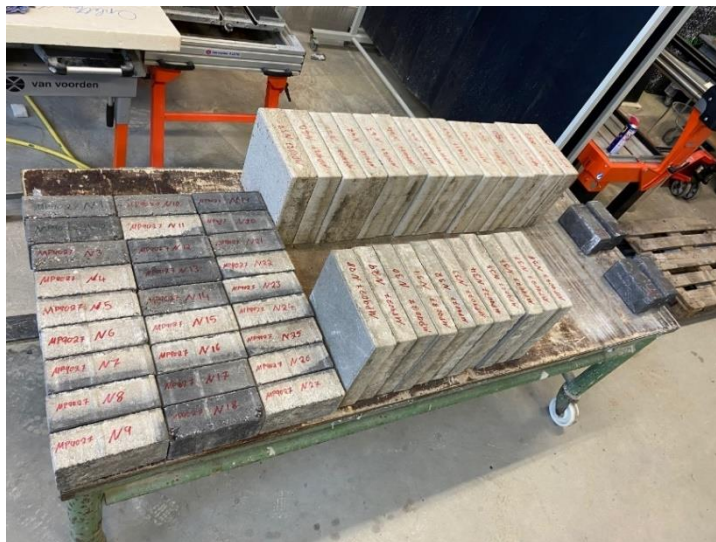
Figuur 29. Pilot Gemeente Dordrecht: overzicht verschillende toegepaste geopolymer betonwaren (al dan niet met toplaag).
