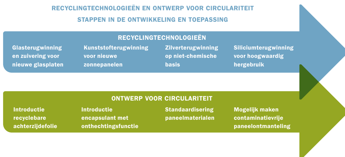
Figuur 15: Stappen in de ontwikkeling en industriële toepassing van recyclingtechnologieën en ontwerp voor circulariteit (indicatieve volgorde).
