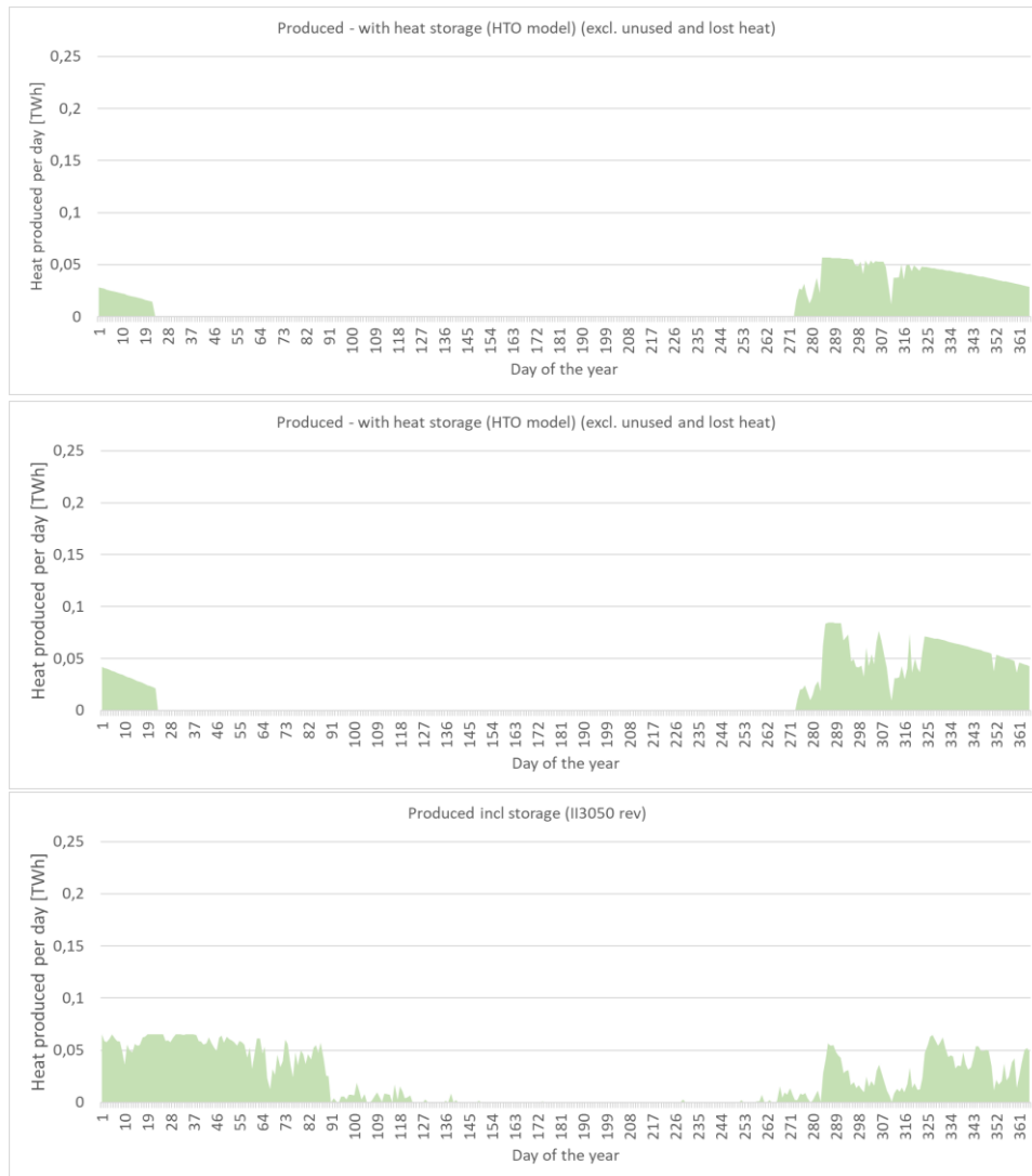
Figuur A.5. Profiel van de drie voorbeelden van productie uit HT-ATES (scenario REG2050). Bovenste: originele input inclusief geïmplementeerd HT-ATES-model uit deze studie. Onderste twee: revisie van input met respectievelijk het HT-ATES-model uit deze studie en het warmtebuffermodel van ETM.
