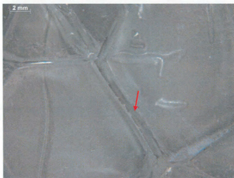
Figuur 5.9: Ruit 5. Stereomicroscopische foto van het centrale breukvlak in het vlinderpatroon met de locatie van het insluitel
