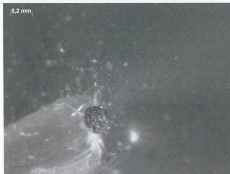
Figuur 5.6: Ruit 4. Stereomicroscopische foto's van het insluitel
