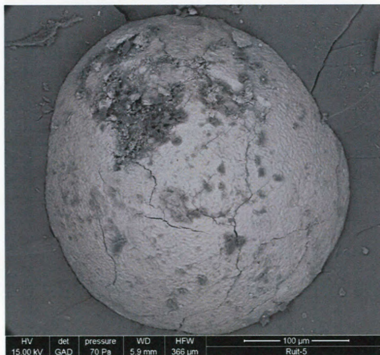
Figuur 5.20: Ruit 5. SEM opname van het insluitsel op het centrale breukvlak van het vlinderpatroon. EDS analyse laat zien dat het om NiS gaat
