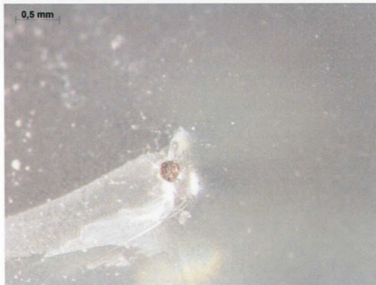
Figuur 5.5: Ruit 4. Vlinderpatroon; de rode pijl geeft het breukvlak met insluitel aan
