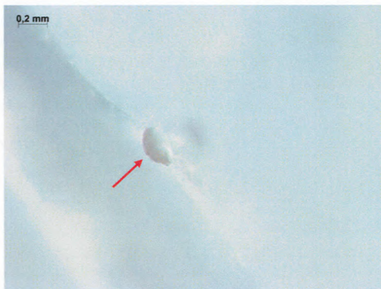
Figuur 5.10: Ruit 5. Stereomicroscopische foto van insluitel op breukvlak
