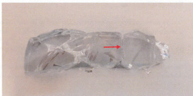
Figuur 5.8: Ruit 5. Vlinderpatroon; de rode pijl geeft het breukvlak met insluitel aan
