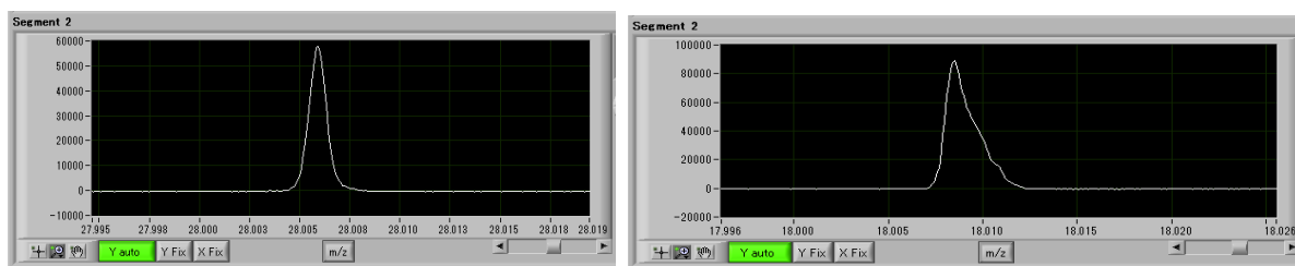
Figuur 9 Links massa piek m/z 28 van stikstof originele tune setting (stikstof), rechts massa piek water m/z 18 gebruik makend van tune settings m/z 28.
