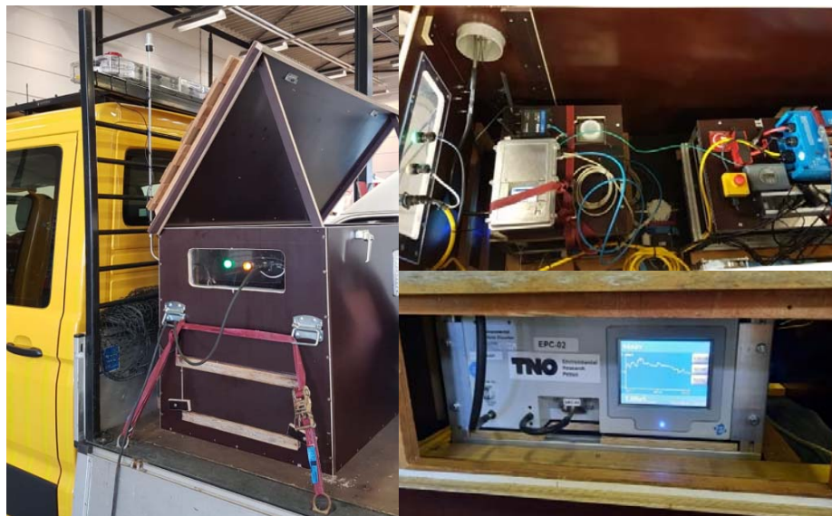
Figuur 3. Meetopstelling in een kist in de Crafter met aanzuigopeningen aan de bovenkant van de cabine (links). In de kist is de apparatuur ingebouwd: EPC (foto rechtsonder) en NanoMonitor (grijze box in de foto rechtsboven).
