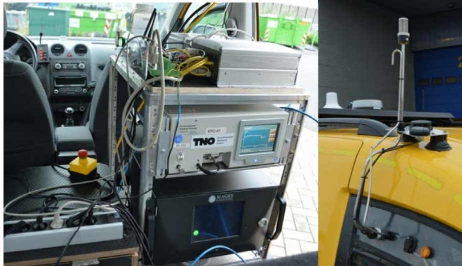
Figuur 2. Meetopstelling in de Caddy (links): met op bovenste plateau de PC en NanoMonitor, in het midden de EPC en onderin de AE33. De aanzuigopeningen van de meetopstellingen zijn gemonteerd op het dak van de Caddy (rechts).
