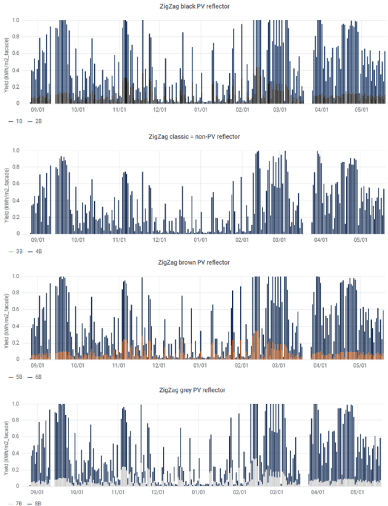
Figuur 24: Dagelijkse opbrengst [kWh/m²_facade] voor alle rijen. De up-facing rijen (met even nummers) zijn geplott in blauw, maar hebben in de opstelling een zwarte kleur. Alle andere kleuren in deze plots zijn gelijk aan de echte kleuren van de PV-panelen. De legenda van rij 3 is wél afgebeeld, maar deze rij produceert geen elektriciteit want bevat een niet PV-actieve plaat.
