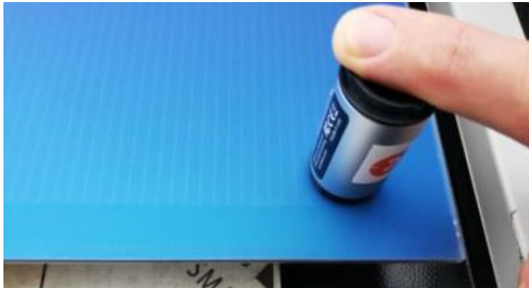
Figuur 11: Kleur meting m.b.v. een colorimeter (van het merk ColorMuse).
