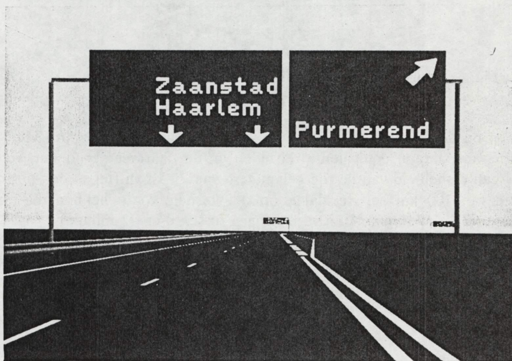
Fig. 8 Standaardwegwijzer (beslisbord) op de entree van de Ringweg.
