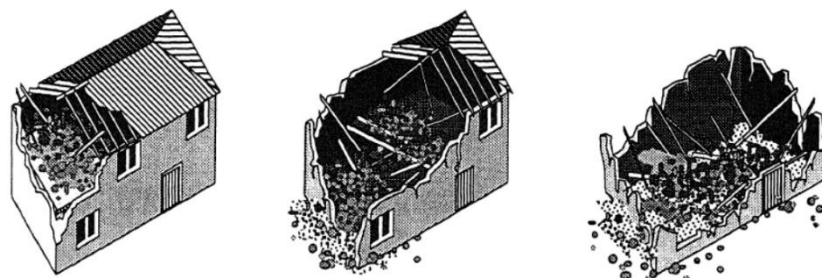
Figuur C.1: Voorbeelden van bezwijkvormen en mate van instorting (debris) bij verschillende/toenemende Collapse State (gedeeltelijk/ volledig instorten); van links naar rechts: CS1, CS2, CS3.
