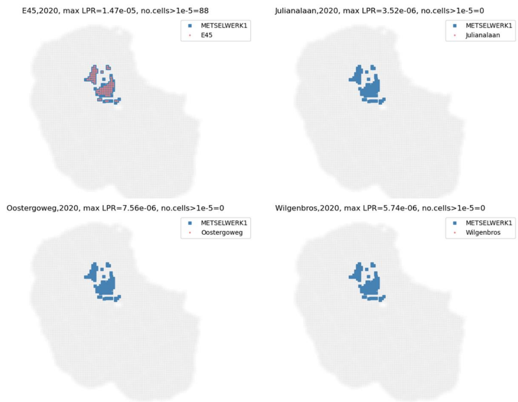
Figuur B.2.1. Vlekkenkaarten voor t5. In blauw de cellen van de vlekkenkaart waar de METSELWERK1 typologie boven de Meijdam-norm uitkomt, in roze markers de cellen waar het risico voor het desbetreffende indexgebouw boven de Meijdam-norm uitkomt. Boven elke vlekkenkaart is de maximum LPR waarde aangegeven voor het betreffende indexgebouw.
