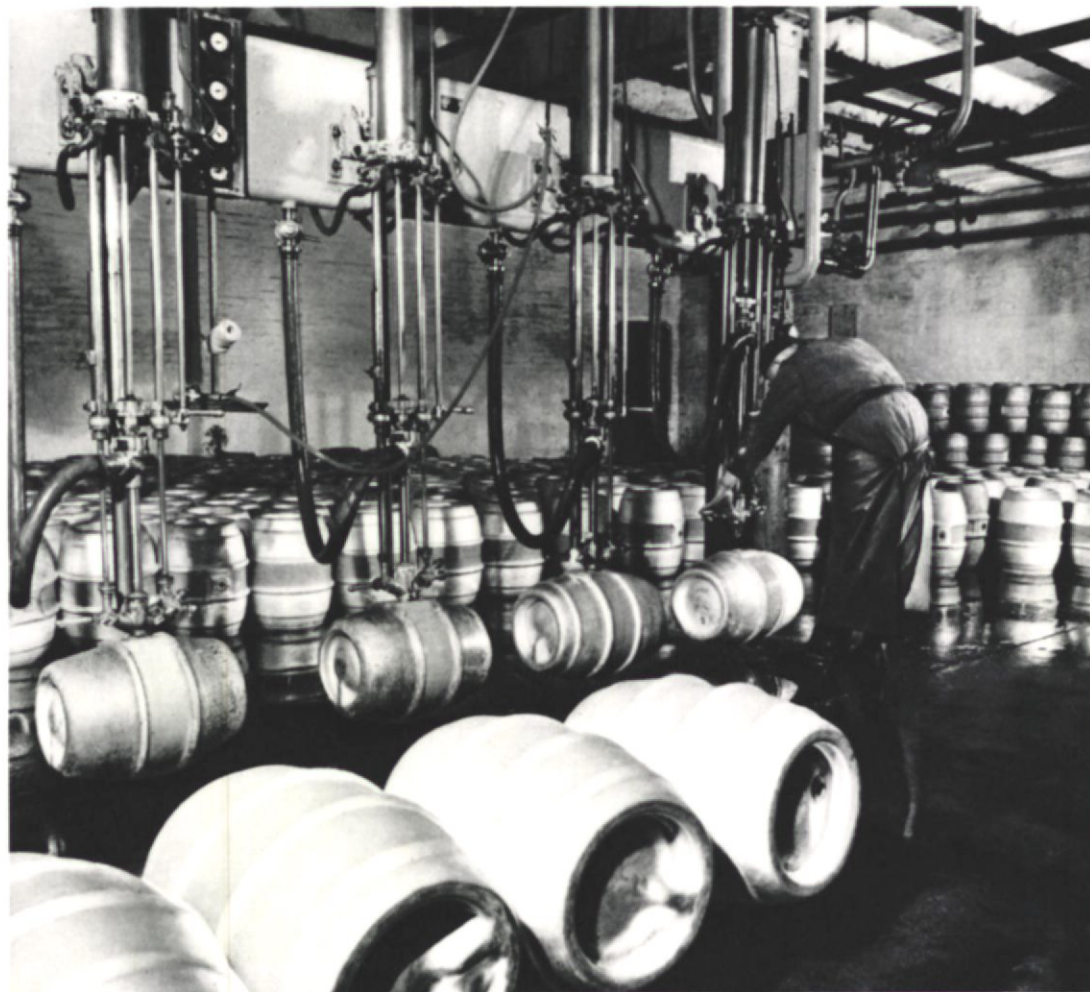
Met tegendruk worden de fusten gevuld.
