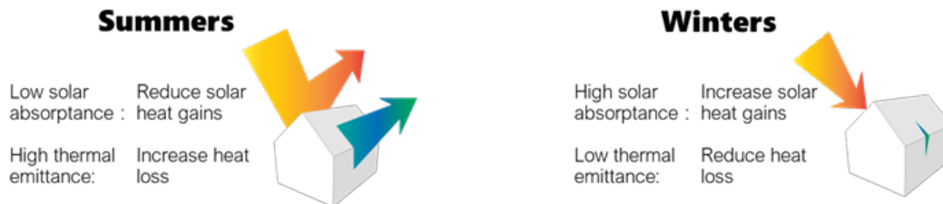
Figuur 4. Het optimale gedrag van de gebouwschil verschilt per seizoen
