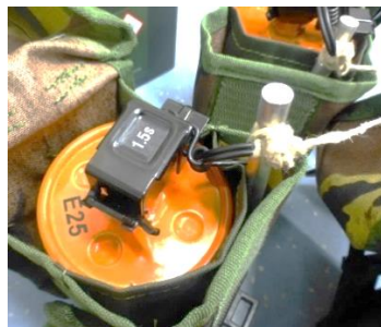
Figuur 3 Testconfiguratie met pen gestoken door en vastgeknoopt aan trekking.
