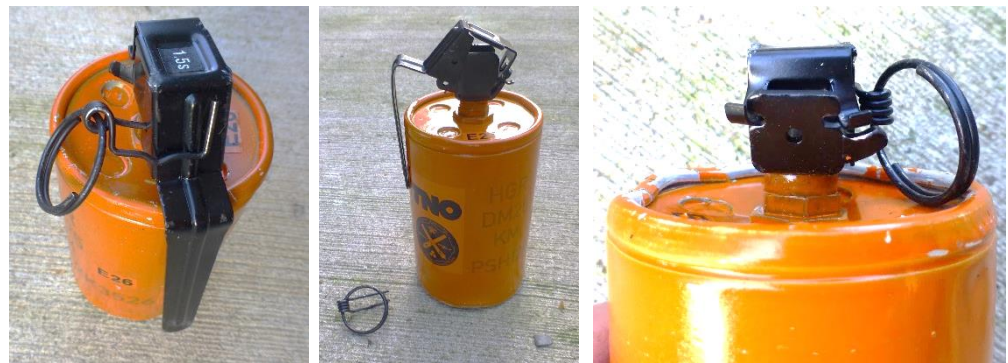
Figuur 17 Repeterende Hard Drop belasting kan leiden tot losraken van de trekkring, kraken en loskomen van de veiligheidspen uit de gaten (links), loskomen van veiligheidshefboom en vervorming van de hefboom (midden) en vervorming van de voetjes (rechts).
