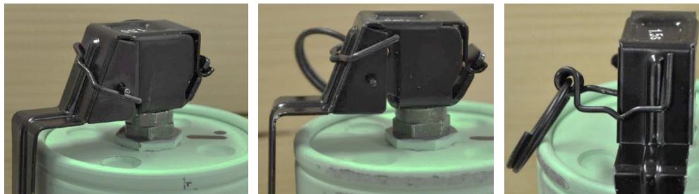
Figuur 13 Veiligheidsmechaniek in organieke stand met ongekraakte geklemde veiligheidspen (links), met gekraakte veiligheidspen in vier gaten (midden) en met gekraakte veiligheidspen in twee gaten [KCWM 28104, 2018].
