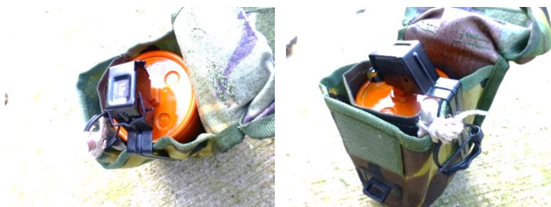
Figuur 15 Repeterende Soft Drop belasting kan leiden tot het kraken van de veiligheidsspen onder invloed van een vreemd voorwerp in hetzelfde tasje als de rookhandgranaat (links), wat vervolgens kan leiden tot het loskomen van de hendel (rechts).
