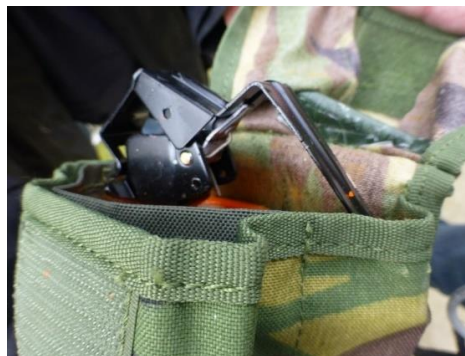
Figuur 19 Veiligheidshefboom is losgekomen na repeterende Hard Drop belasting maar rotatie van de hefboom is onvoldoende om inslag van de slagpin toe te laten.
