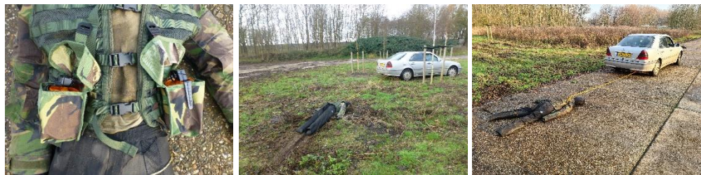
Figuur 7 Dummypop met ops vest met daarin bevestigd twee tasjes met rookhandgranaten (links), drag test door gras (midden) en over steen (rechts).
