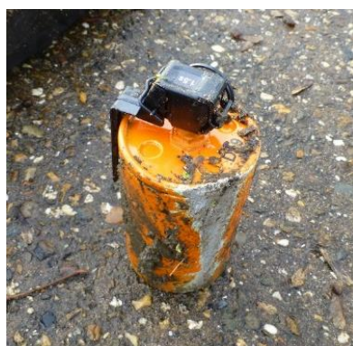
Figuur 23 Vervorming van rookhandgranaatlichaam na Drag test over steen.
