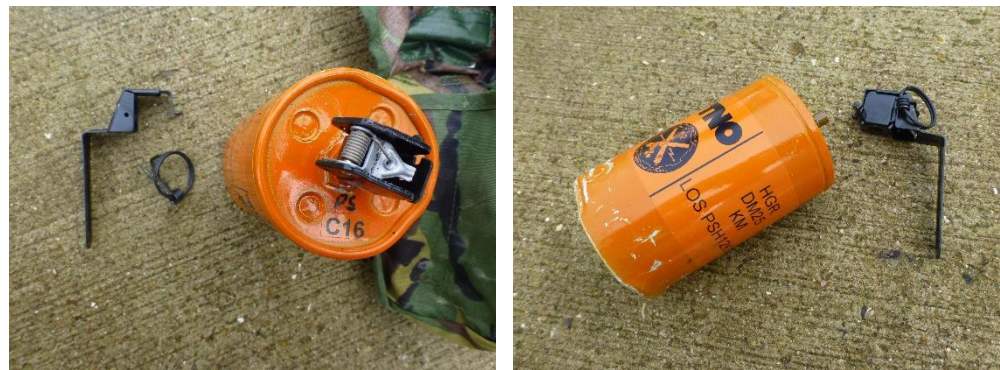
Figuur 21 Ingeslagen slagpin (links) en losgeslagen veiligheidsmechaniek na Impacttesten (rechts).
