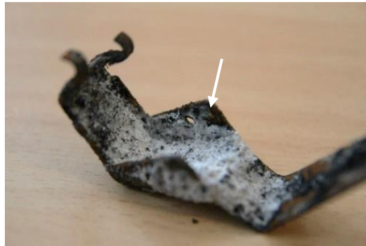
Figuur 15 Residu aan de binnenzijde van de veiligheidshefboom. Een driehoekig vlak naast het borggat aan beide binnen zijwanden van de hefboom is niet bedekt met residu.
