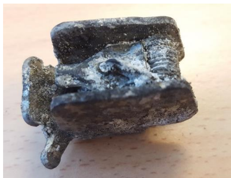
Figuur 29 Slagpin van de DM25 na afloop van experiment 3-1.
