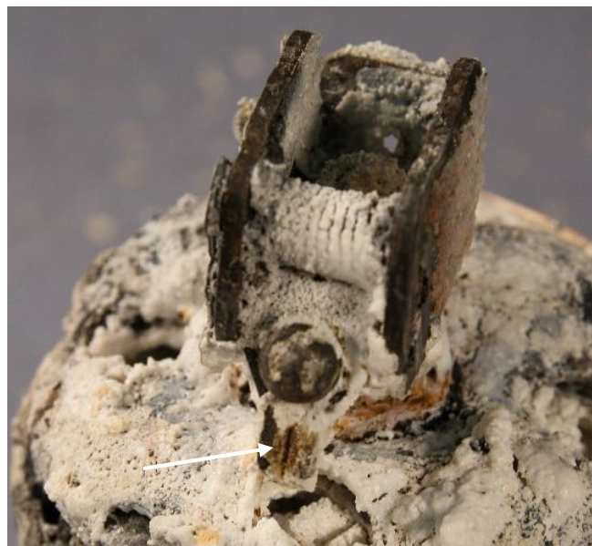
Figuur 38 Ontstekerlichaam van de granaat geïnitieerd door middel van een squib. De slagpin (aangeduid met een witte pijl) zit vast in de uitgangspositie en de veer functioneert niet meer.
