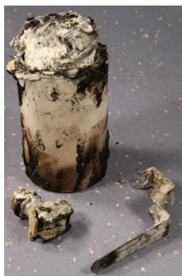
Figuur 28 Resultaat van experiment 3-1: de veiligheidshefboom en ontstekerlichaam zijn beide van de granaat losgekomen. Het deksel is sterk vervormd en omhoog gedrukt.
