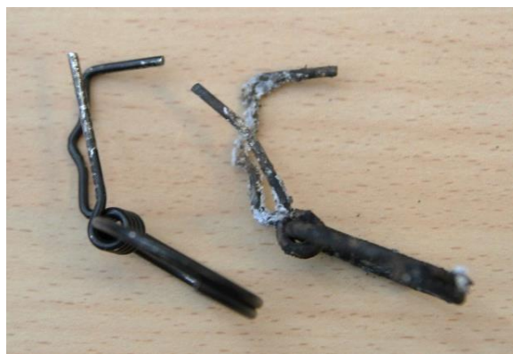
Figuur 14 De enigszins kromme veiligheidspen van de ongevalsgranaat (rechts) en een rechte pen (links) die is verwijderd uit de veiligheidshefboom bij normaal functioneren.
