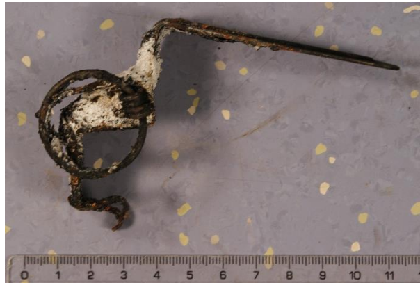
Figuur 5 Veiligheidshefboom en veiligheidspin van de ongevalsgranaat.
