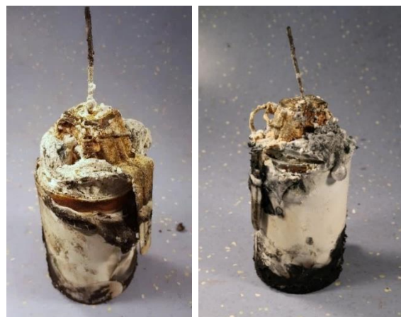
Figuur 33 Resultaat na initiatie door middel van pin en valgewicht in ongekraakte stand (links) en gekraakte stand (rechts).
