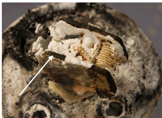
Figuur 26 Resultaat van experiment 2-1: de slagpin is ingeslagen en door het residu zit het vast aan het slaghoedje.
