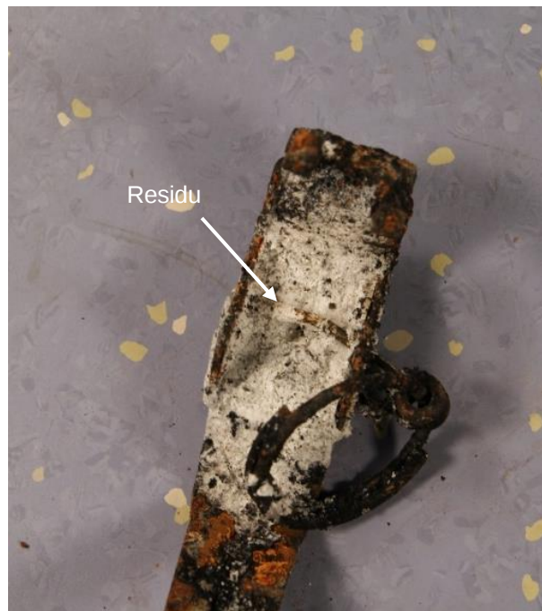
Figuur 6 Residu op de veiligheidspen aan de binnenzijde van de veiligheidshefboom.
