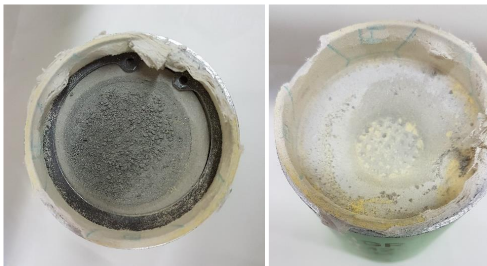
Figuur 18 Boven aanzicht na openen granaatlichaam; een afsluitring is zichtbaar met daaronder een folie met een aanvuursas (links). Hieronder bevindt zich de rooklading met daarop een vuurversterksas en een centrale holte (rechts).
