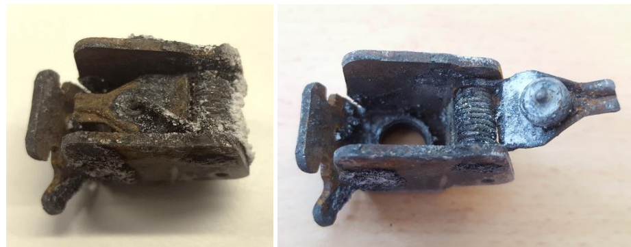
Figuur 9 Ontstekerlichaam van de ongevalsgranaat: links in de positie zoals aangetroffen na het ongeval, en rechts na terugbuigen van de slagpin met behulp van een tang.
