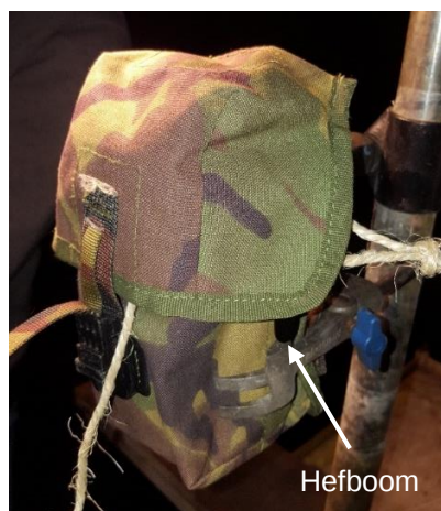
Figuur 21 Experiment 1-1; de hefboom is buiten het tasje geplaatst en het tasje is afgesloten met het kapje.
