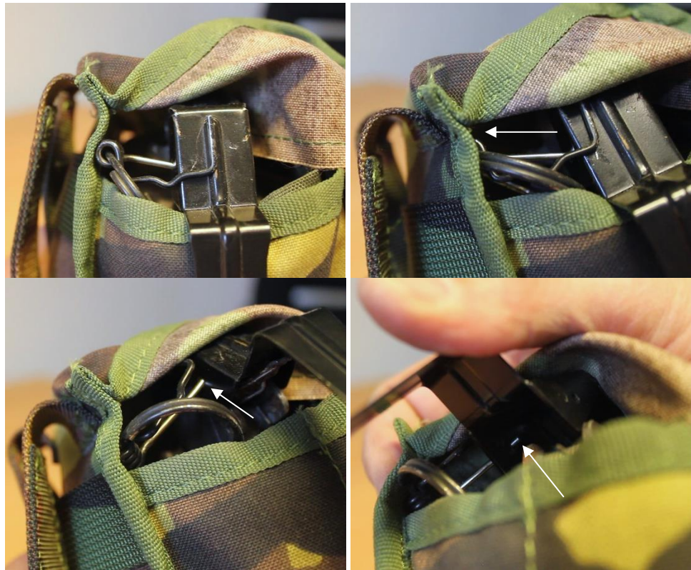
Figuur 42 Scenario waarbij de veiligheidspen de uiterste positie bereikt waarna de hefboom voldoende roteert voor inslag van de slagpin en de pen door het tasje terug in de hefboom wordt geduwd.
