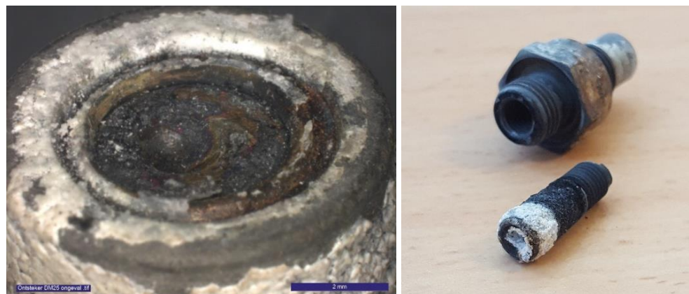
Figuur 12 Details van de ontsteker uit de ongevalsgranaat (links: bovenzijde slaghoedje; rechts: vlampijpje).
