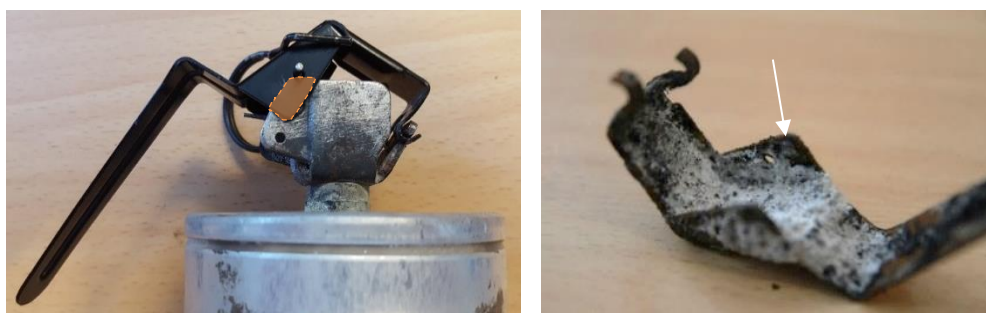
Figuur 41 Positie van de veiligheidshefboom tijdens het branden van de ongevalsgranaat; de vorm van het gearceerde vlak (links) komt overeen met het ontbreken van residu op een deel van de binnen zijwanden van de hefboom (aangeduid met witte pijl rechts).
