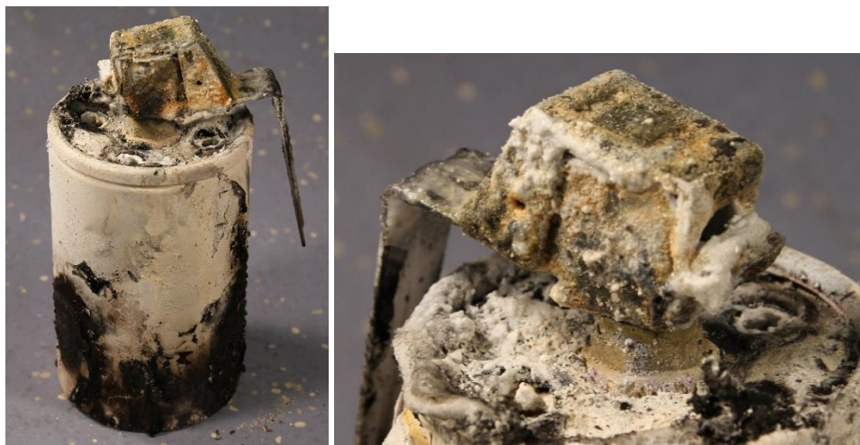
Figuur 25 Resultaat van experiment 2-1; de veiligheidshefboom staat vrijwel in de uitgangspositie (veilige stand) en zit nog vast aan het ontstekerlichaam.
