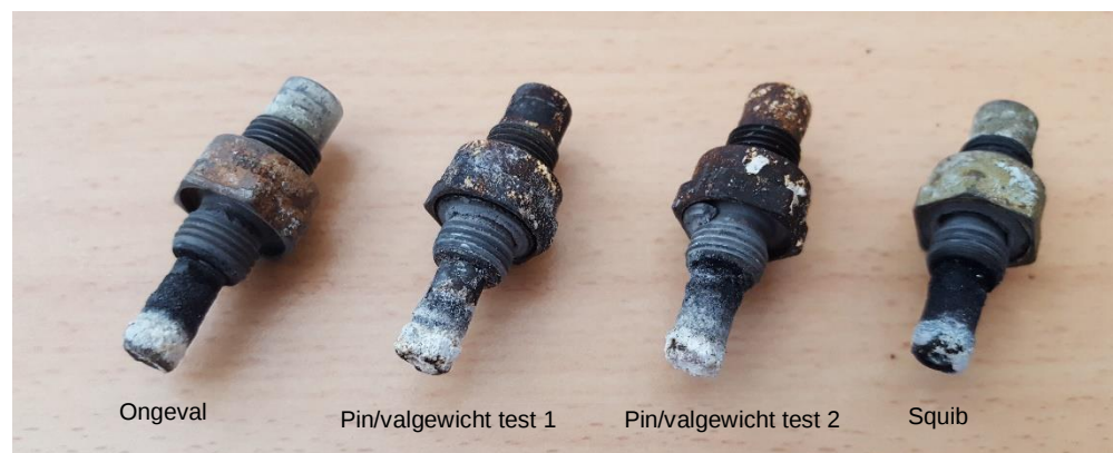
Figuur 40 Ontstekers uit de ongevalsgranaat en de granaten die in geborgde (veilige) stand zijn geïnitieerd door een pin en valgewicht en door een squib.
