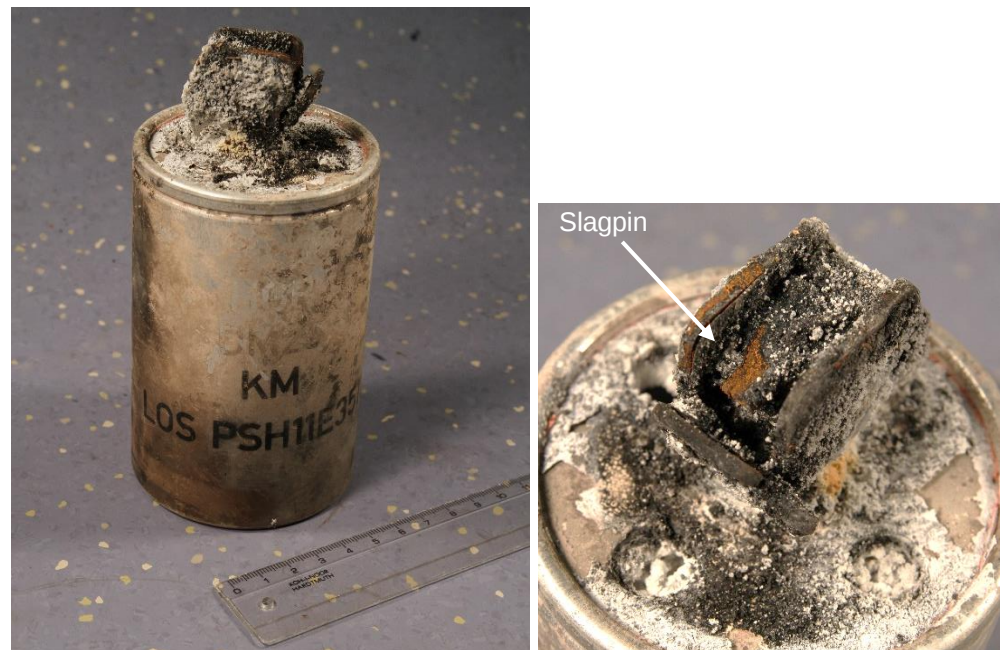
Figuur 4 Granaatlichaam met ontstekerlichaam en ontsteker van de ongevalsgranaat.
