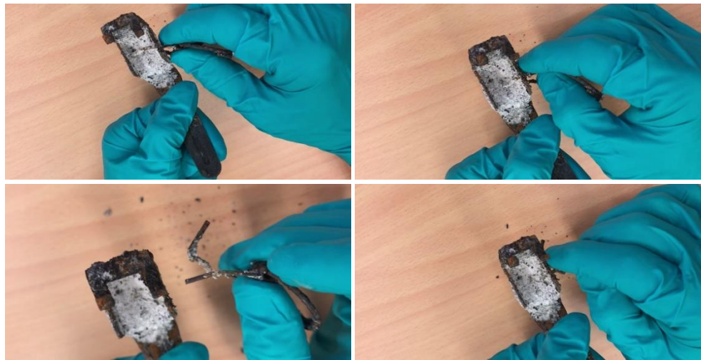
Figuur 13 Verwijderen van de veiligheidspen; uitgangspositie (linksboven), enkele millimeters losgetrokken (rechtsboven), enkele millimeters resterend (rechtsonder) en geheel verwijderd (rechtsonder).
