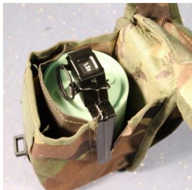
Figuur 27 Experiment 3-1: de hefboom is in het achterste van de twee binnenvakjes geplaatst. Het tasje wordt deels ingeknipt om de hefboom ruimte te geven voor rotatie.
