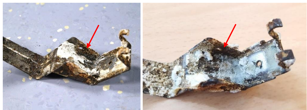
Figuur 35 Veiligheidshefbomen van de twee rookgranaten die zijn geïnitieerd door middel van een pin en valgewicht in ongekraakte stand (links) en gekraakte stand (rechts). De binnen zijwanden (aangeduid met een rode pijl) van beide hefbomen zijn relatief schoon.
