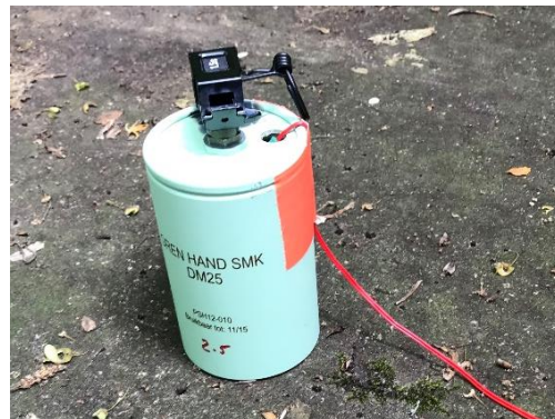
Figuur 36 Initiatie van de rooklading door middel van een squib.
