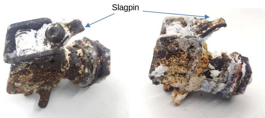
Figuur 34 Ontstekerlichamen van de twee rookgranaten die zijn geïnitieerd door middel van een pin en valgewicht in ongekraakte stand (links) en gekraakte stand (rechts). De slagpin zit vast in de uitgangspositie en de veer functioneert niet meer.
