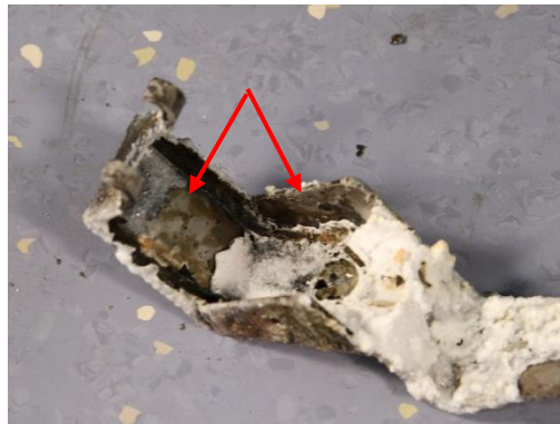
Figuur 39 Veiligheidshefboom van de rookgranaat die is geïnitieerd door middel van een squib. De binnen zijwanden van de hefboom (aangeduid met een rode pijl) zijn relatief schoon.
