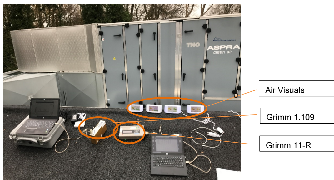
Figuur 29 Woensdag 2 december 2020 (week 49), vergelijking Airvisual fijnstof meetapparatuur voor lokaal N6, N7 (referentie) met Grimm 1.109 (links onder) en Grimm 11-R (rechtsonder).
