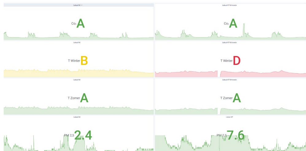
Figuur 48 Dashboard smart sensor systeem voor automatische toetsing binnenklimaat, als voorbeeld week 49, 2020. Linkerkolom: testlokaal N6, rechter kolom: referentielokaal N7. Van boven naar beneden indicatoren voor CO 2 , T_winter, T_zomer en PM 2.5 (fijnstof). Groene lijnen en tekst geven aan dat het lokaal voldoet aan klasse A frisse scholen. Geel, oranje en rood geven respectievelijk klasse B, C en D aan. Bij PM 2.5 wordt ook de gemiddelde waarde weergegeven.
