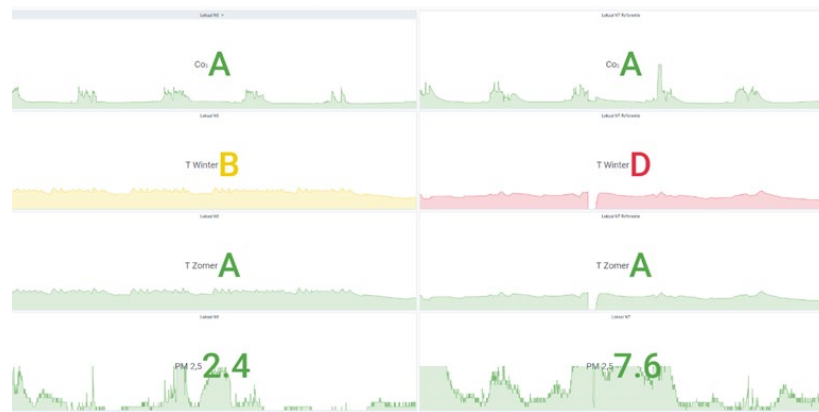
Figuur 2 Ontwikkelde smart sensing dashboard voor de eindgebruiker, links geklimatiseerd lokaal N6 en rechts referentielokaal N7 gedurende een week.
