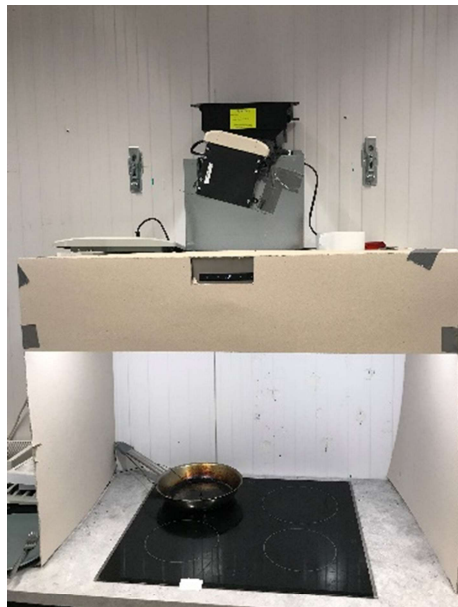
Figuur 5 Meetopzet fijnstofmetingen. Bovenop de afzuigkap is de filterbox zichtbaar waarin de te beproeven filters kunnen worden geplaatst.
