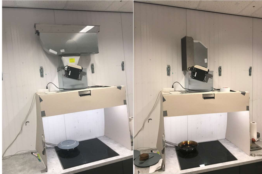
Figuur 9 Filtertesten ten behoeve van down-draft, links 'groot' filter kool + F7 debiet 618 m 3 /uur, rechts 'klein' filter kool + F7 debiet 510 m 3 /uur.
