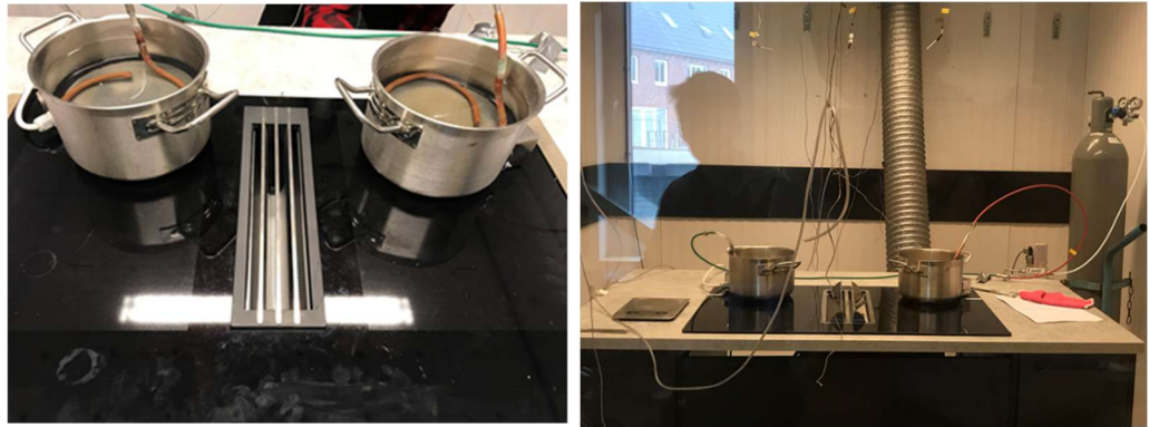
Figuur 16 Down-draft toestel met afvoer naar buiten met twee elektrisch verwarmde pannen gevuld met water en CO 2 dosering. In de rechter figuur zijn de temperatuursensoren en de aanzuigslangen van de CO 2 sensoren zichtbaar
