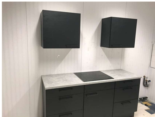
Figuur 14 TNO test keuken voor recirculatie afzuigkappen volgens norm IEC 61591 op basis van inductie.
