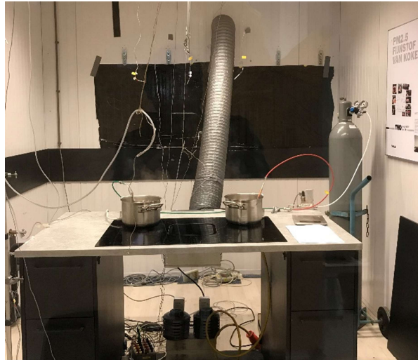
Figuur 2 Experimentele opstelling voor het testen van down-draft toestellen
