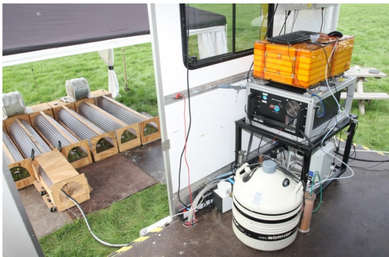
Figuur 1: Foto van de windtunnelopstelling met de windtunnels buiten onder een tent en de QCL in de meetwagen. De QCL meet \text{NH}_3 en tevens \text{CH}_4 , \text{N}_2\text{O} , \text{H}_2\text{O} , 10 metingen per seconde.
