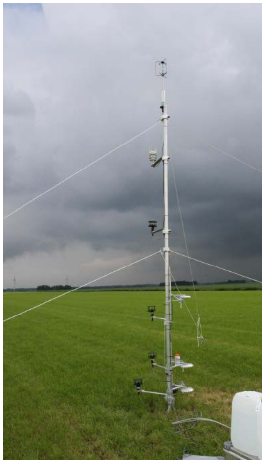
Figuur 4: Meteo mast met wind op 6 hoogtes voor de windmetingen.
