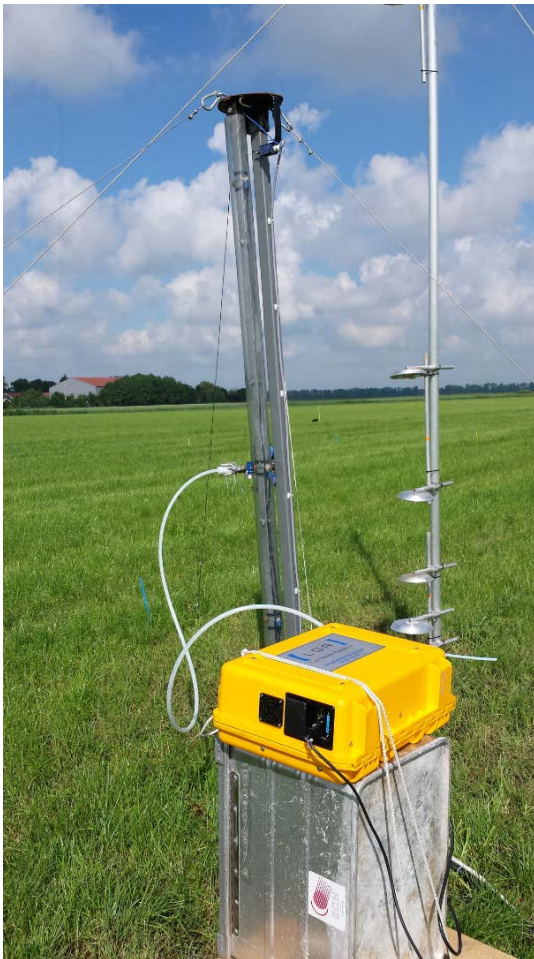
Figuur 16: Metingen met de alfa samplers (schoteltjes aan de aluminium mast) en met de portable los Gatos met de inlaat op een liftje.
