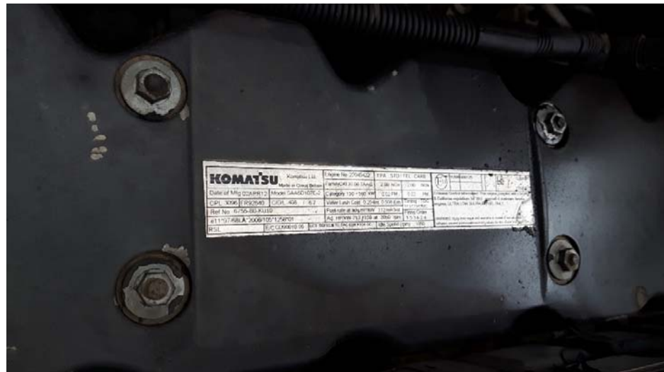
Figuur 4: Het motorplaatje, waarop de typekeuring volgens Europese Richtlijn 97/68/EC (Stage IIIa, Stage IIIb en Stage IV) genoemd staat. Uit de datum 2 april 2012 en het vermogen volgt dat deze motor aan Stage IIIb limiet van 2 g/kWh moet voldoen in de officiële test.
