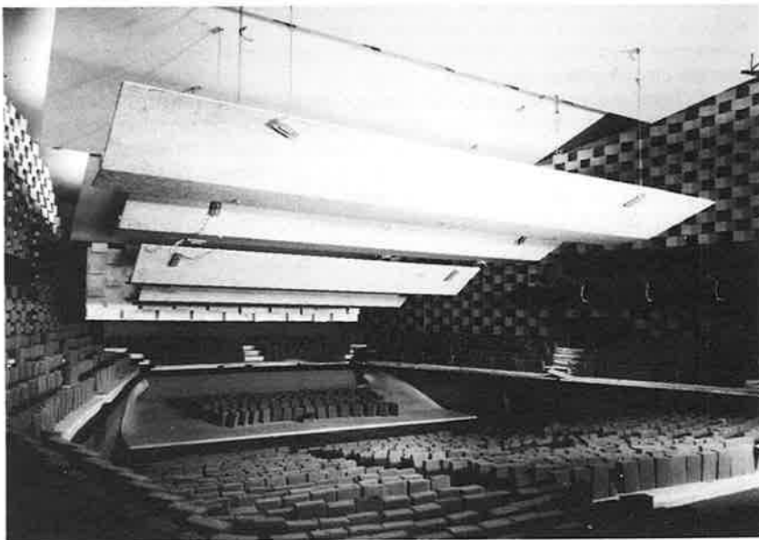
Schaalmodel 1:10 van de Grote Zaal van de Doelen te Rotterdam.
