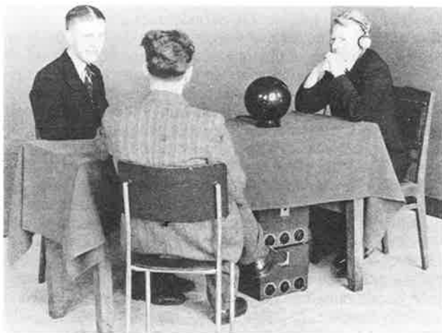
Kunsthof van K. de Boer als akoestisch hulpmiddel voor een slechthorende. Door gebruik van twee in een kunsthof geplaatste microfoons, die elk één telefoon voeden, is ook het richtingshoren mogelijk gemaakt.
