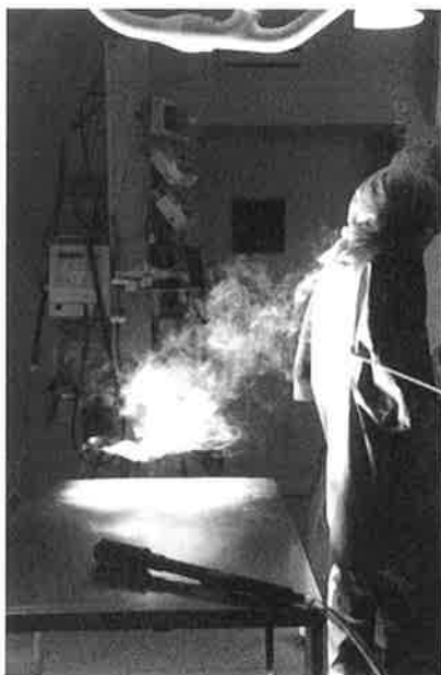
Luchtwervelingen achter het operatieteam, boven de instrumententafel
