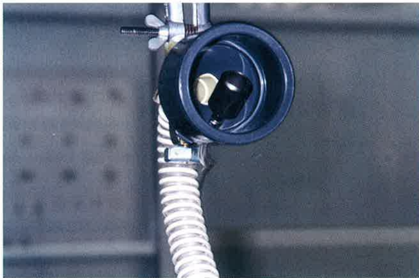
Gecombineerde aanzuigopening voor de Miran en de LPC
