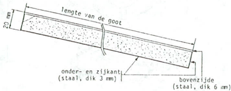
Figuur B.1.43: Damping met ingesloten droog zand
