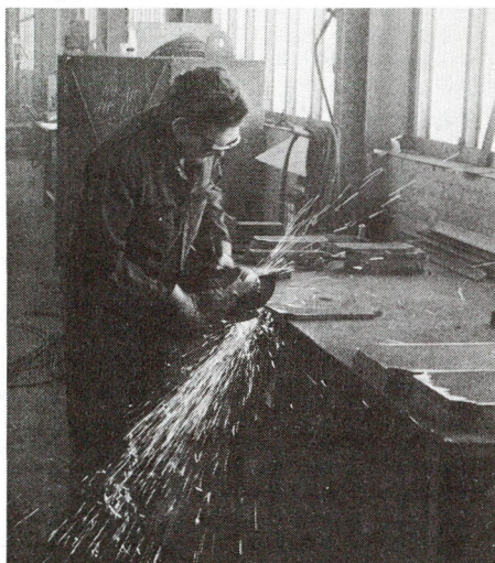
Figuur B.6.1: Slijpwerkzaamheden
