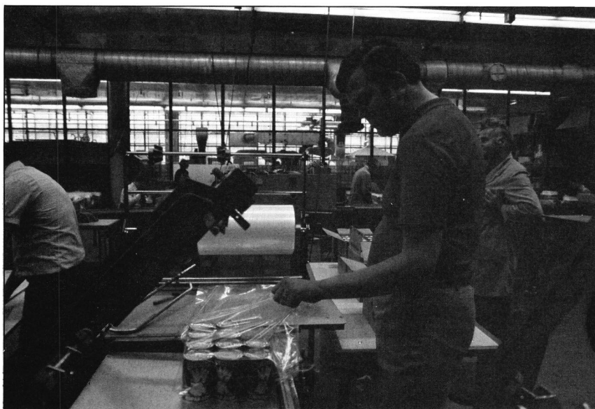
Het automatiseren van het in kunststoffolie verpakken van artikelen bleek in de praktijk niet goed te werken. Bij het handmatig sealen werd het apparaat regelmatig schoongemaakt; na automatisering liet men het apparaat rustig vervuilen. De motivering en het vakmanschap ging verloren. Foto: DGSW, Rotterdam
