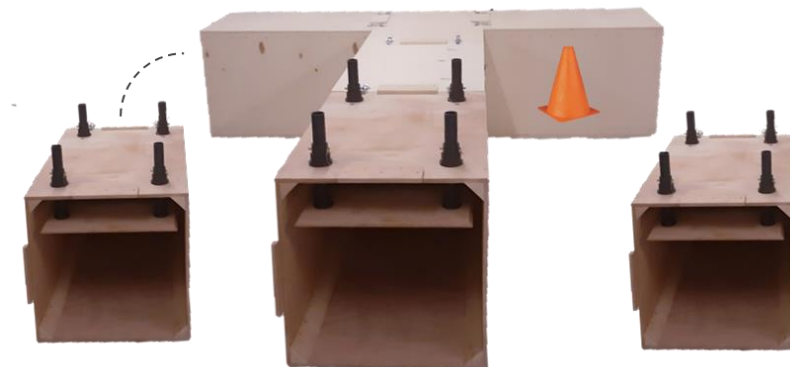
Figuur 18 Confined spaces obstakel, tunnel met T-splitsing en verstelbare doorsnede(2019).
