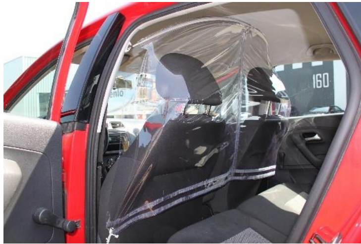
Figuur 3. Flexibele transparante afscheiding tussen bestuurder/bijrijder en passagiers achter.
