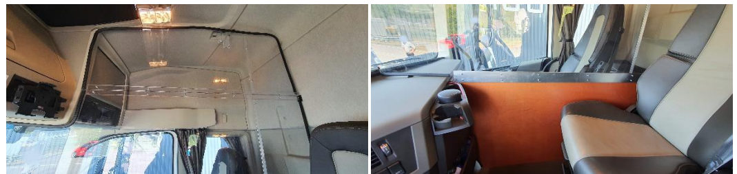
Figuur 1. Complete afscheiding met hard kunststof in een vrachtwagencabine. Links: bovenste deel; rechts: onderste deel.
