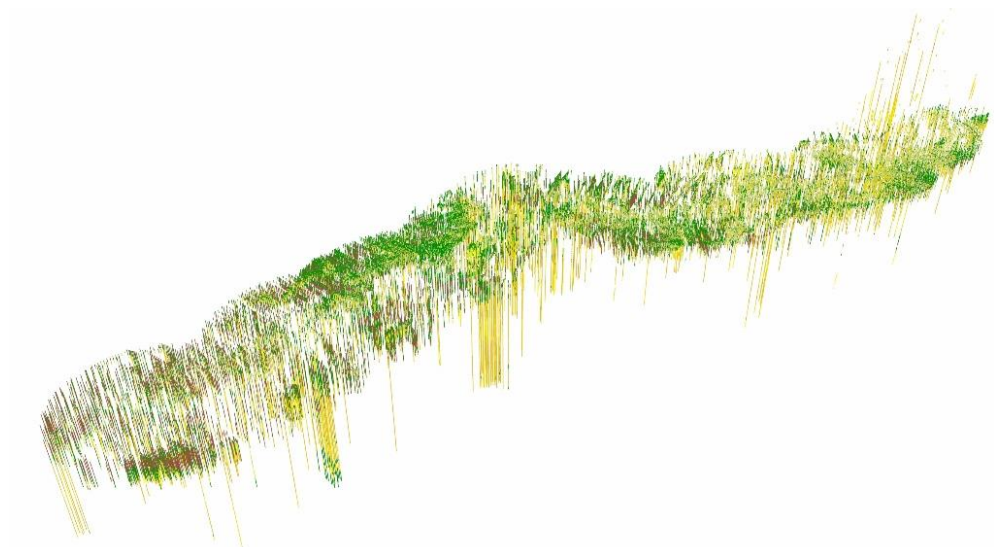
Figuur 4-3 3D weergave van boormonsterbeschrijvingen langs de Lek waarbij de kleuren verschillende lithoklassen weergeven.
