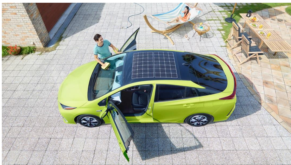
Figuur 25: Ontwerp van een elektrische auto met geïntegreerde PV als range extender [27].
