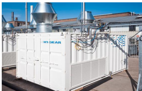
Figuur 5 Prototype membraanmodule van HyGear voor scheiding van waterstof
