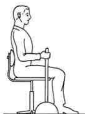
Figuur V-29. De kracht van de arm in zithouding is maximaal iets boven ellebooghoogte. Hierbij is tevens de nauwkeurigheid van bewegen maximaal (Brown 1948).
