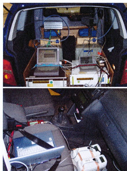
Figuur 1: NO x -monitoren met bijbehorende laptops achterin (afbeelding boven); deeltjestellers met laptop op passagiersstoel (onder).
