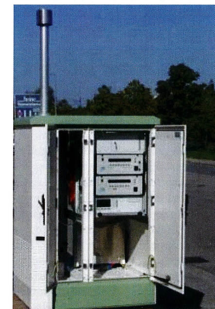
Figuur 3: Een minicontainer (UMEG, Karlsruhe, Germany).
