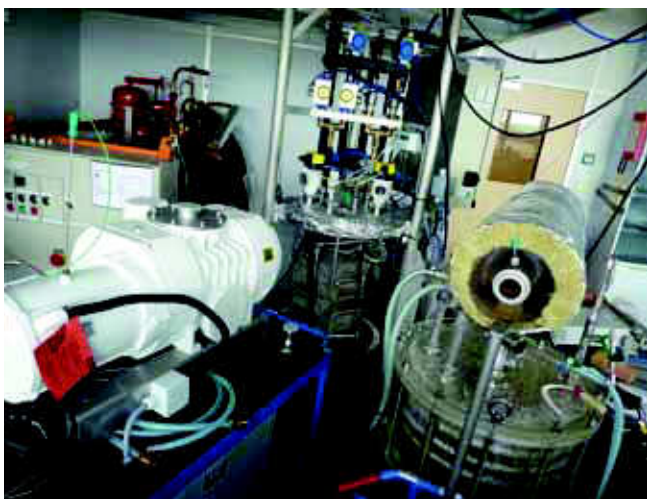
Opstelling hybride silicagel-water compressiesysteem met links(voor) de compressor, in het midden de reactor en rechts de condensor en verdampert.
