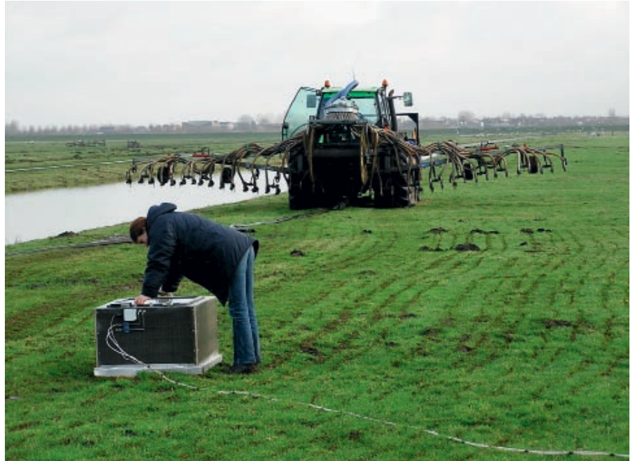
Figuur 2: a) Snelle kamermeting uitgevoerd op een intensief beheerd veenweidegebied. b) Automatische kamermeting uitgevoerd te Cabauw.
