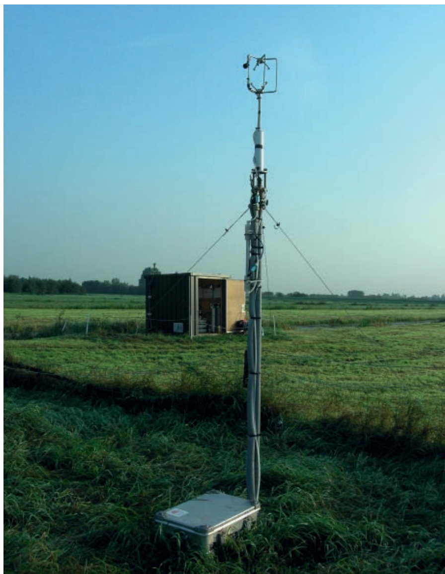
Figuur 3: a) Schematische weergave van het oppervlak ( footprint ) waarvan de emissies worden gemeten met behulp van eddy covariance-flux-metingen. Het symbool w staat voor de verticale windsnelheid en c voor de concentratie. b) Foto van een eddy covariance-mast geïnstalleerd op een intensief beheerd veenweidegebied.
