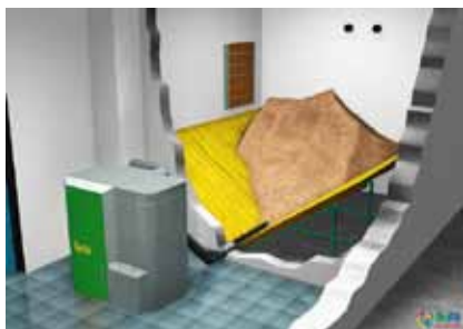
Opslag van pellets met automatische toevoer [14]
