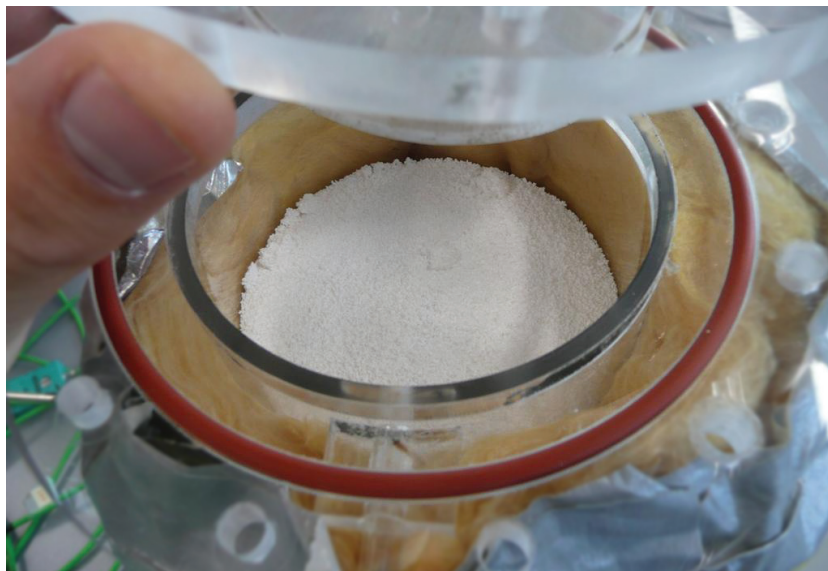
Het grofkorrelige magnesiumchloride-hydraat in de laboratoriumopstelling.
